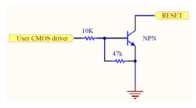
**Figure 5 Reset Pin Diagram**
